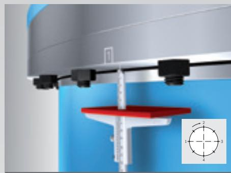
Илл. 7: Принцип измерения осевого перемещения с помощью штангенглубиномера
