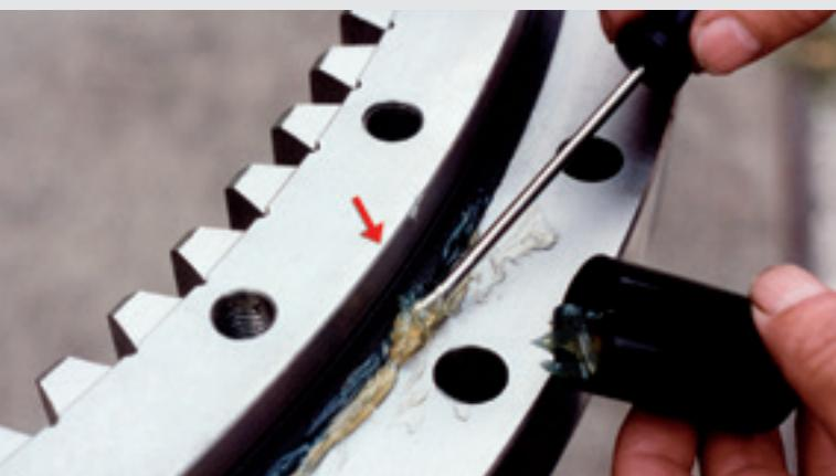
Bild 16: Fettentnahme an der Dichtlippe
