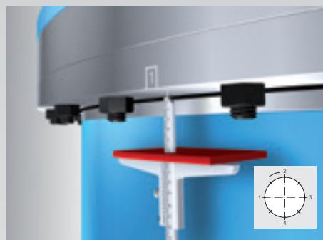
Figura 7: Estructura principal de la medición de asentamiento con calibrador de profundidades
