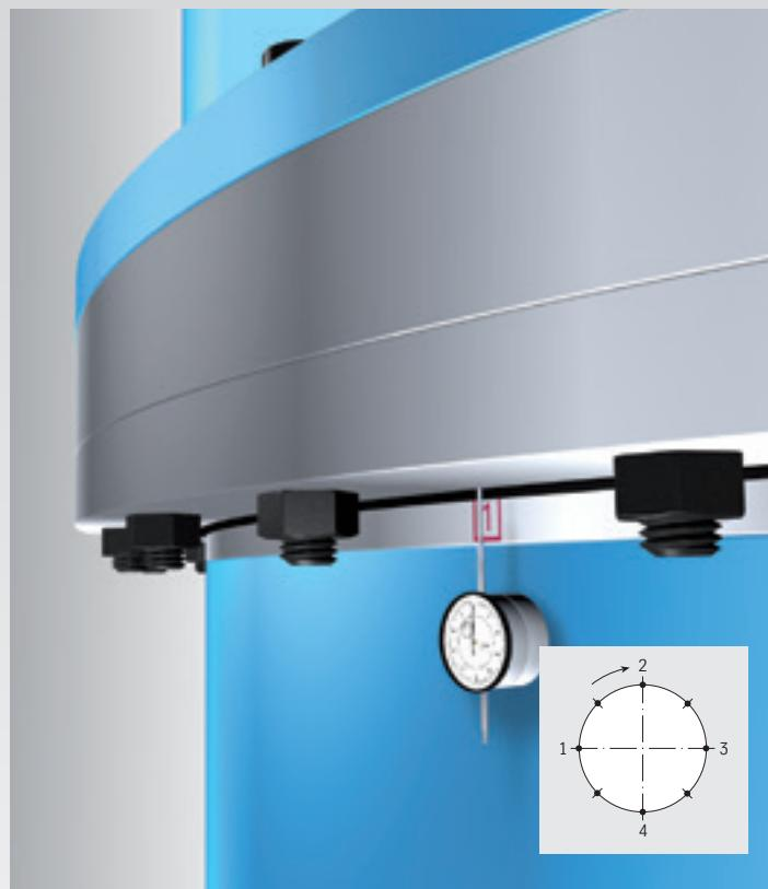
Bild 5: Prinzipieller Aufbau der Kippspielmessung
