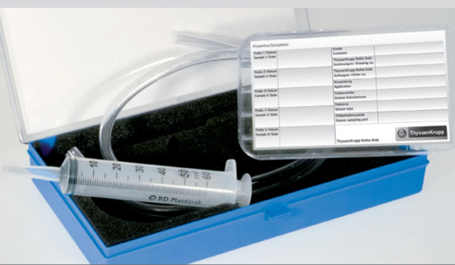
Figura 11: Kit para coleta de amostra de graxa
