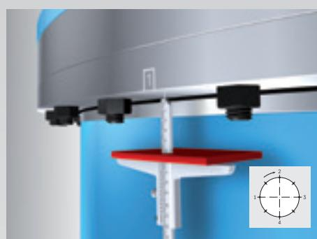
Figure 7 : Principe structurel de la mesure d'affaissement avec un pied à coulisse de profondeur
